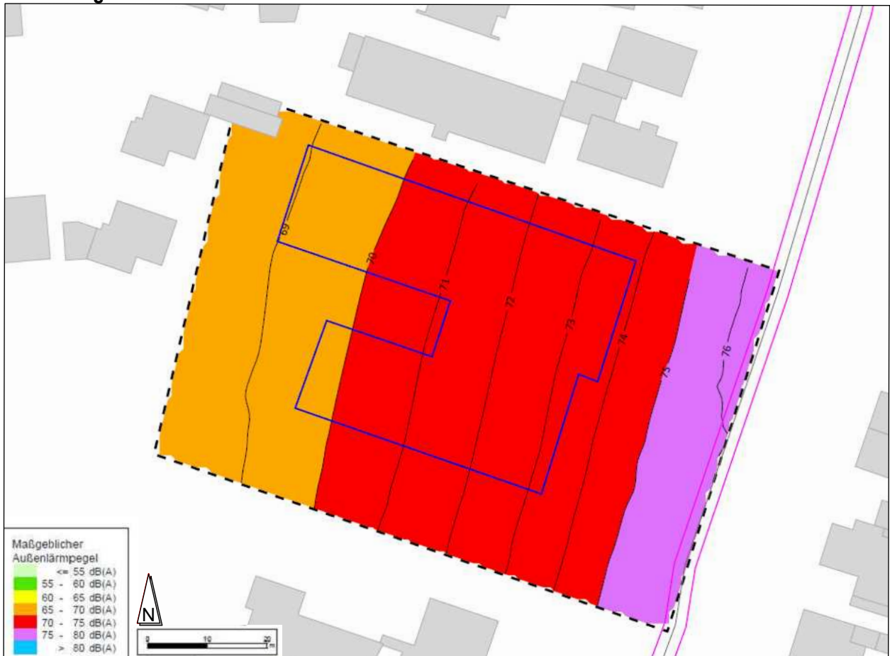
NEBENZEICHNUNG 2: Maßgeblicher Außenlärmpegel für Räume, die überwiegend zum Schlafen genutzt werden können
