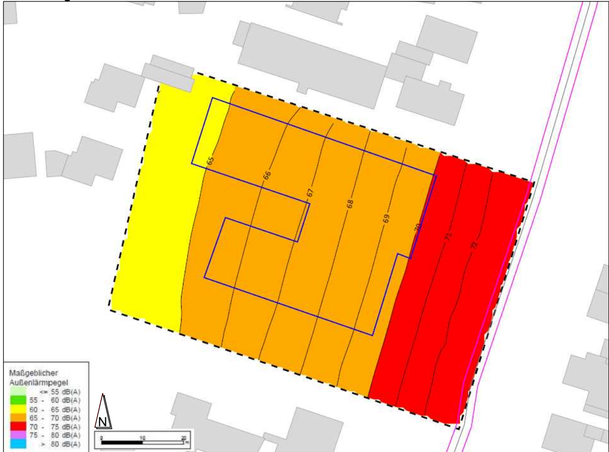
NEBENZEICHNUNG 1: Maßgeblicher Außenlärmpegel für Räume, die nicht überwiegend zum Schlafen genutzt werden können
